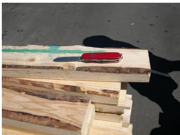
Image 3. Écorce sur le bord d'une planche. Le couteau mesure 2 cm par 15 cm. La planche respecte donc les niveaux de tolérance liés à l'écorce. La planche qui se trouve en dessous de celle sur laquelle le couteau est apposé ne contient que de la flache (cambium décoloré) et est donc conforme.
