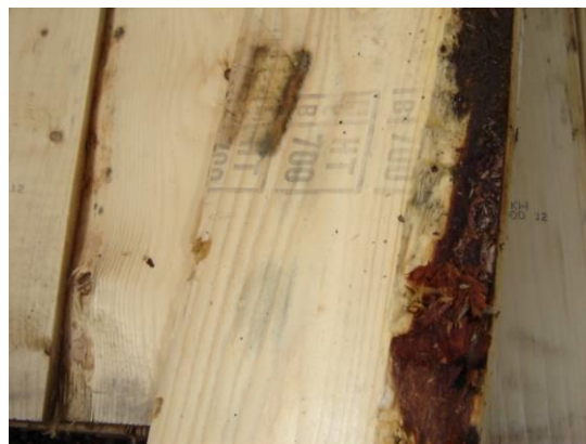
Image 2. L'écorce sur le bord de la planche est inférieure à 3 cm de largeur. La planche respecte donc les niveaux de tolérance liés à l'écorce.
